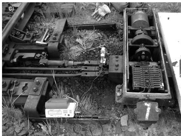
Fot. 2. Trzpieniowa metoda pomiaru sił nastawczych a) pomiar trzpieniem EZK, b) pomiar trzpieniem \mu MOZ-a, c) widok całego układu pomiarowego
