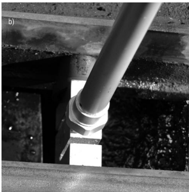
Fot. 3. Pomiar sił nastawczych przyrządem MS450 a) pomiar przyrządem MS450; b) głowica pomiarowa MS450 podczas pracy
